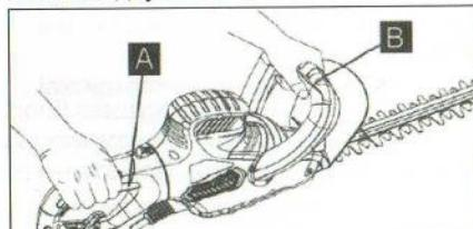
Включение кустореза за счет одновременного нажатия двух выключателей реализовано для того, чтобы пользователь не смог повредить руки о режущий блок.
